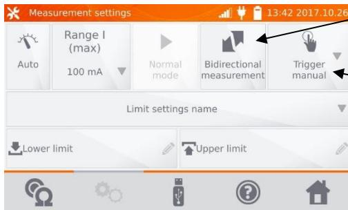
Commutación Medición Unidireccional/medición Bidireccional.
