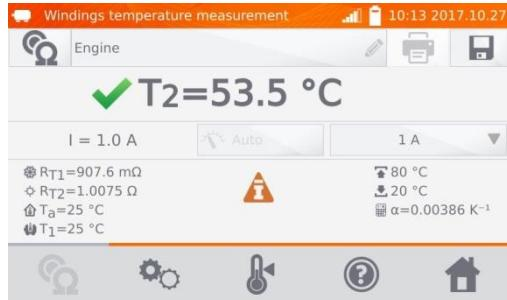
$R_{T1}$  – resistencia del bobinado frío
