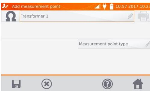
Al hacer clic en **Tipo del punto de medición** se puede seleccionar el tipo por defecto o introducir su propio tipo.
