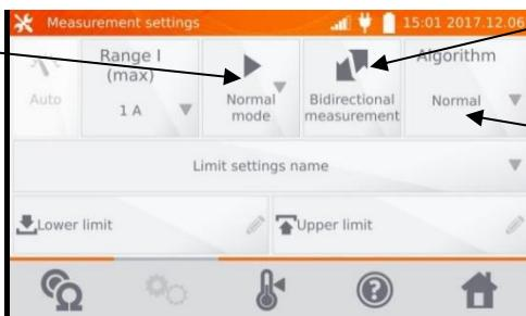
Commutación Medición Unidireccional/Medición Bidireccional.
