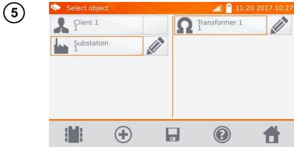
Después de añadir y guardar el punto de medición, hacer clic en . El resultado se guarda en la memoria, el medidor vuelve al modo de medición.
