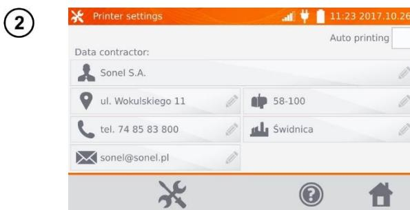
Al hacer clic en los campos individuales, se pueden modificar los datos de las mediciones que se imprimirán. Marcar la casilla **Auto impresión** hace que se imprima automáticamente la impresión al guardar el resultado en la memoria, si la impresora está encendida.
